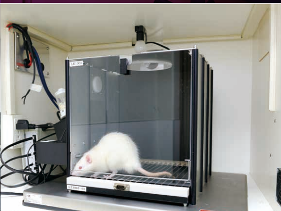
スキナー箱 ラットにレバー押しの学習をさせる装置です。
