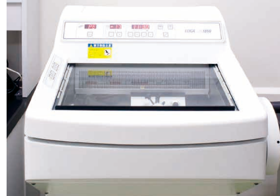
凍結マイクローム 脳切片の標本を作製するための装置です。
