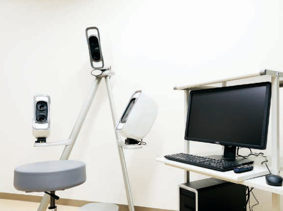
3次元顔画像撮影解析装置 (VECTRA) 人間の顔を3次元で撮影することができ、あらゆる方向から解析することができます。
