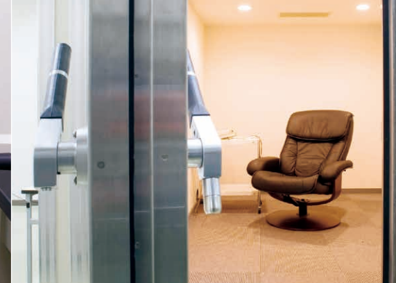
電気音響シールドルーム 脳の働きなど微細な生体現象を測定する部屋です。
