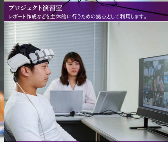
機能的近赤外線分光法 (fNIRS) 生体透過性の高い近赤外光を頭部に照射し、生体内から反射される光の一部を検出することで、脳表面の活動状態を可視化する装置です。
