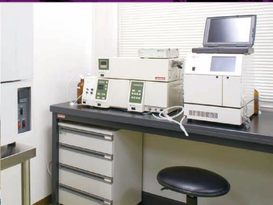
高速液体クロマトグラフィ 脳内から回収した神経伝達物質などを分析します。
