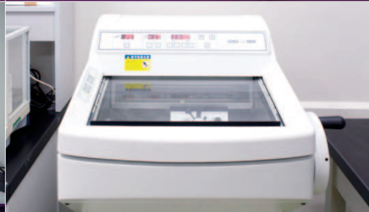
クライオスタット 脳切片の標本を作製するための装置です。
