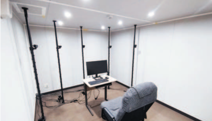
生体信号計測装置・電磁シールドルーム 脳の働きなど微細な生体現象を測定する部屋です。
