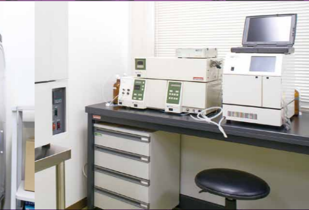
高速液体クロマトグラフィ 脳内から回収した神経伝達物質などを分析します。
