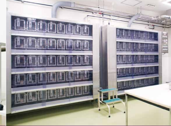
一方向気流式飼育システム 最大160匹のラットが飼育可能な自動給水・洗浄ラックを導入しています。
