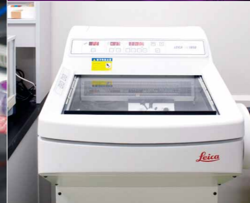
凍結マイクローム 脳切片の標本を作製するための装置です。
